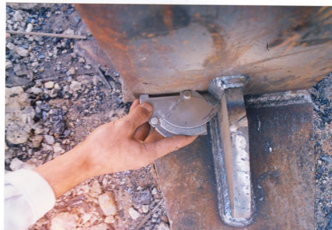
بازرس جوش در حال اندازه گیری ابعاد جوش
