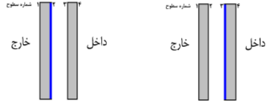
شکل ۸- محل قرارگیری پوشش کم‌گسیل در مناطق سردسیر (سمت راست) و گرمسیر (سمت چپ)
