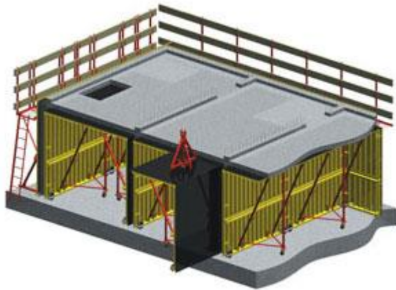
۴. بتن ریزی و انتقال قالب ها
