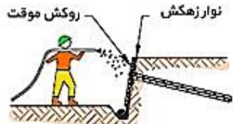
۴- اجرای روکش موقت (شامل نصب شاتکریت، مهره شش گوش، پلیت باربر، واشرا)
